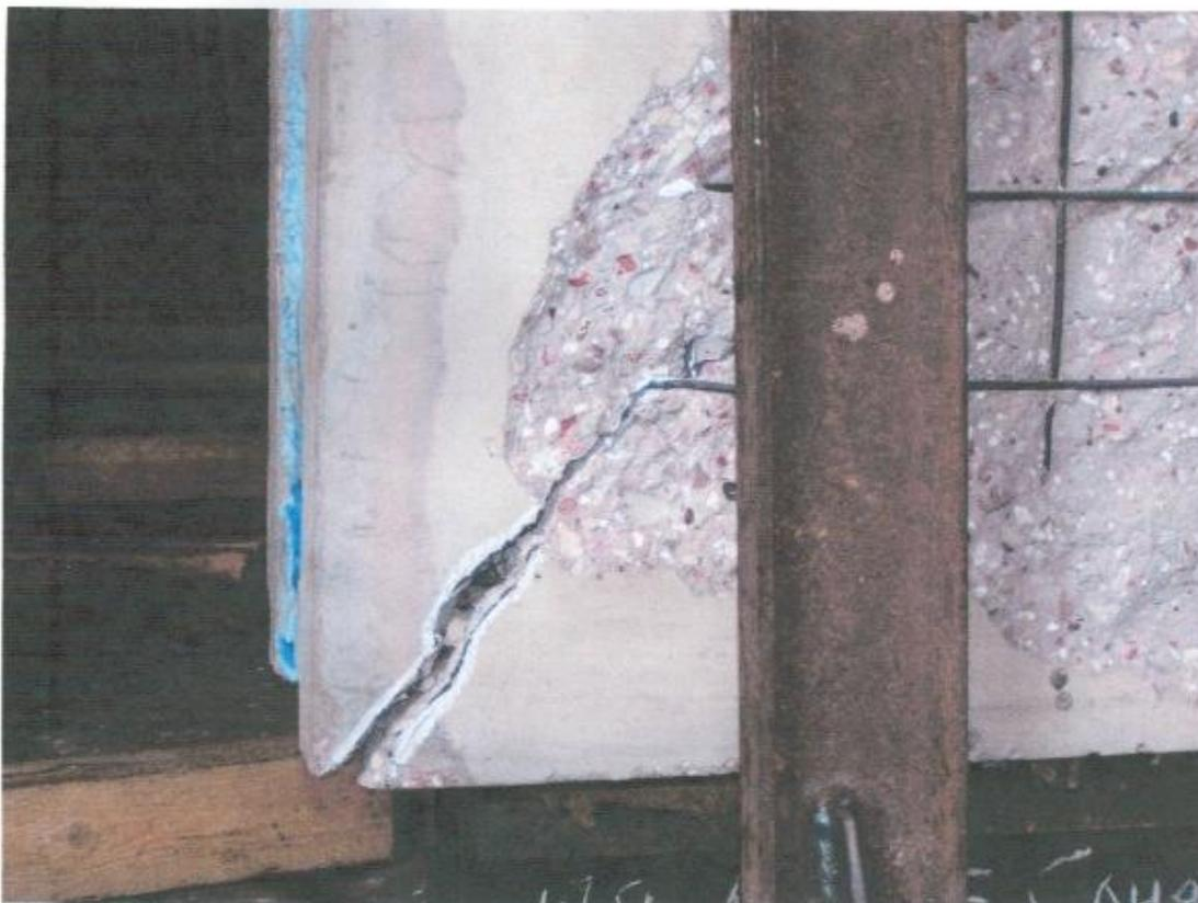
Рисунок 3.10- Трещина в нижнем углу панели после термического воздействия.
