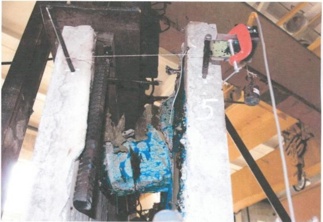
Рисунок 3.13 – Разрыв поперечной арматуры после нагружения.
