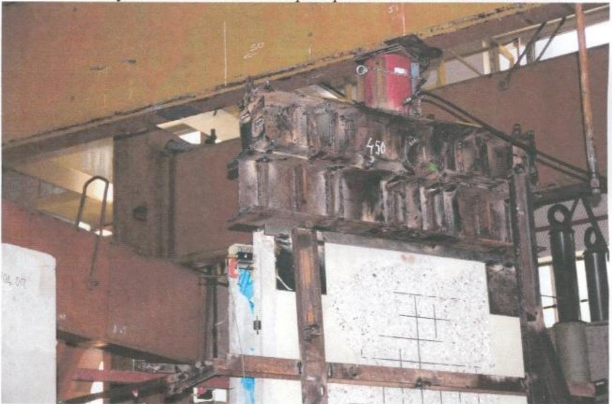
Рисунок 3.7– Приложение нагрузки на панель
