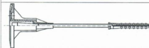
2.4. При закреплении к стене теплоизолирующего слоя из материалов с плотностью 50 кг/м<sup>3</sup> и меньше дюбеля всех типов могут быть (по заказу потребителя) укомплектованы шайбой Ш-100 (рис.3), увеличивающим площадь, через которую на теплоизолирующий материал передается удерживающая сила.
